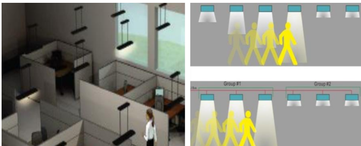
صورة رقم (15) ... توضح تحكم جهاز الاضاءة في كميتها حسب تواجد الاشخاص.
